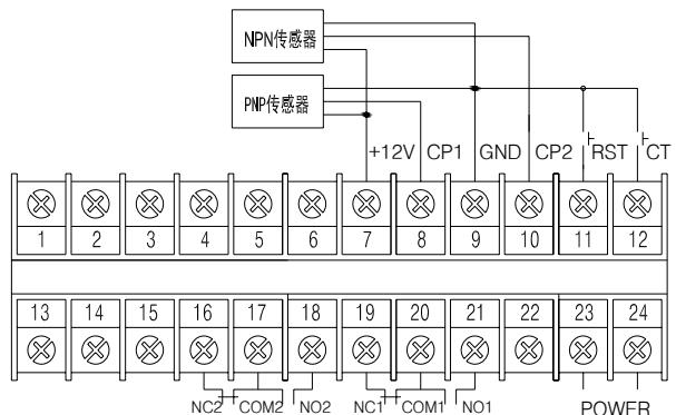
如图所示，COM1、COM2为一、二段输出继电器，端子17、20为输出继电器的公共端，端子18、21为常开触点，端子16、19为常闭触点；端子11（RST）为外部复位信号输入端，低电平计数器立即复位；端子8（CP1）为PNP计数信号输入端；端子9（GND）为信号地；端子10（CP2）为NPN计数信号输入端；端子12（CT）为低频NPN计数信号输入端，当该端接GND时，禁止计数器计数，可用作计数控制端；端子7为+12V电源输出；端子23、24为计数器工作电源交流AC85-265V输入。
